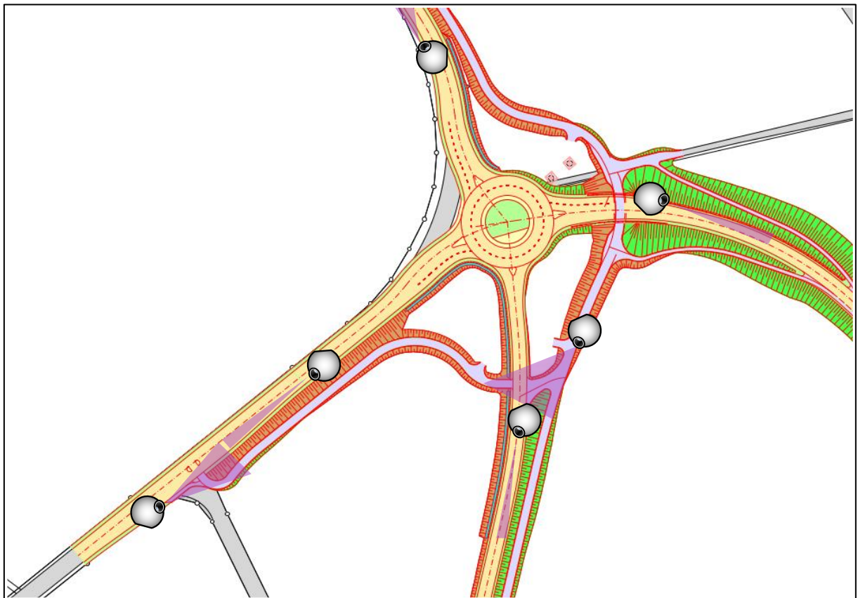
Figure 27 : Utilisation de caméras thermiques pour comptage et détection d'utilisateurs du giratoire
